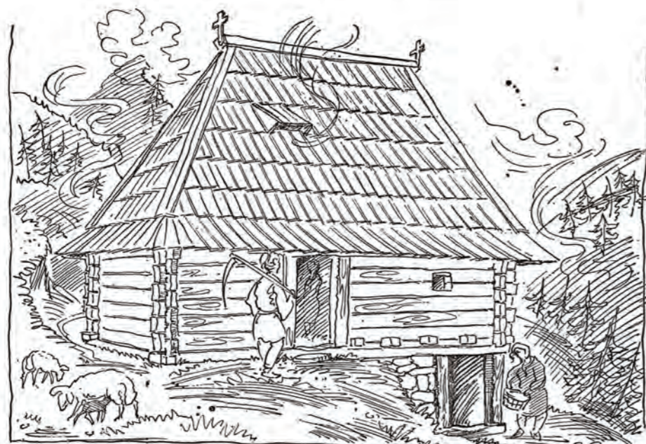
Brvnara „na čelici“, sa podrumom (Crna Gora); izvor: Deroko, A. (1968) Narodno neimarstvo I , crtež 6, str. 24
